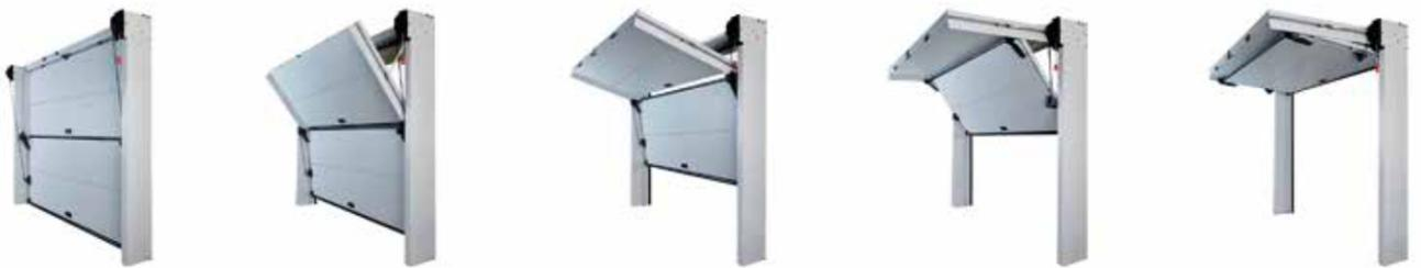
Dies ermöglicht es Platz zu sparen, optisch störende Kabel zu verstecken und den Motor vor äusseren Einflüssen zu schützen. Die Funktion von OVERLAP ist schnellstens beschrieben: Das Torblatt wird vom Motor angehoben, faltet sich in der Mitte zusammen, der obere Flügel dreht sich unter die Garagendecke, der untere Flügel schiebt sich unter den oberen Flügel.
